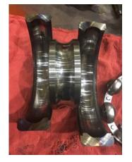
55. Bearing ODE Type MRC 316S-HYB#1 (hybrid) P53
