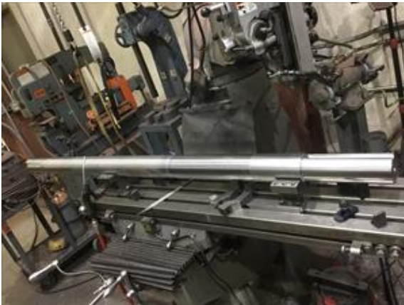
Machined new fan shaft.
