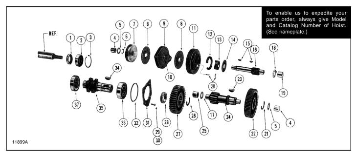
Figure 8-4. GEARING AND LOAD BRAKE PARTS
