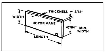
Figure 5-7. Rotor Vane
