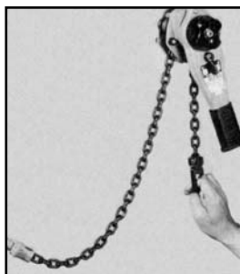
Photo 1 - Palier tendeur de chaîne relâchée
