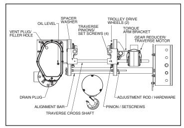
Figure 5-9. Traverse Drive Arrangement
