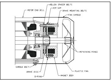
Figure 5-8. Motor Brake
