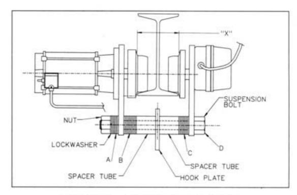
FIGURE 1. TROLLEY TO BEAM INSTALLATION
