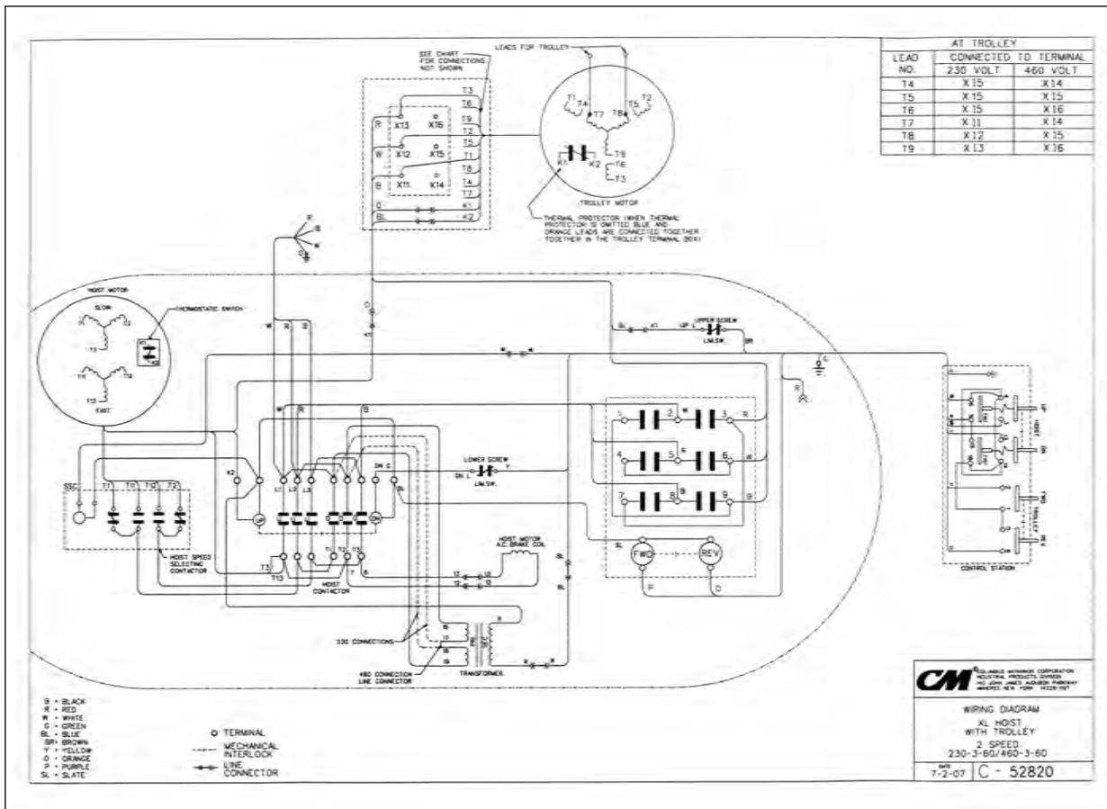
**2 TON - TWO SPEED HOIST WITH TROLLEY**
